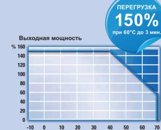
Например, EL-150-24 представляет собой источник питания 24 В постоянного тока, который имеет постоянный рабочий ток 5 А при 60°С и повышение мощности на 150%, что эквивалентно 7,5 А, в течение не менее 3 мин. Эта функция позволяет использовать устройство меньшего размера для питания требовательных нагрузок, таких как электромагнитные клапаны, двигатели, лампы и другие нагрузки с переходной перегрузкой, для которых в противном случае потребовалось бы чрезмерное питание.
