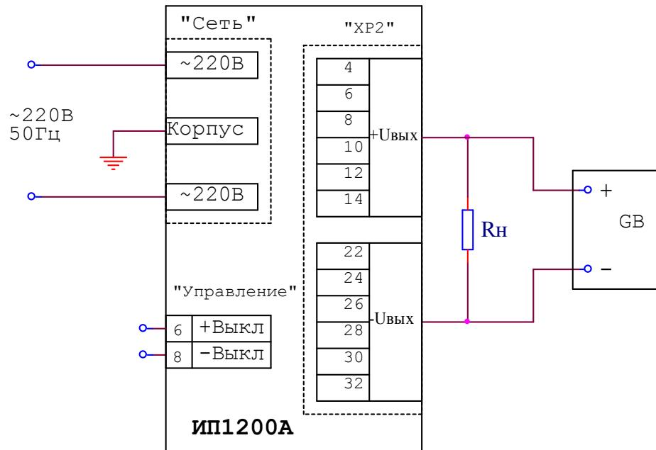
Рисунок Е.2 - Схема включения выпрямителя с аккумуляторной батареей
