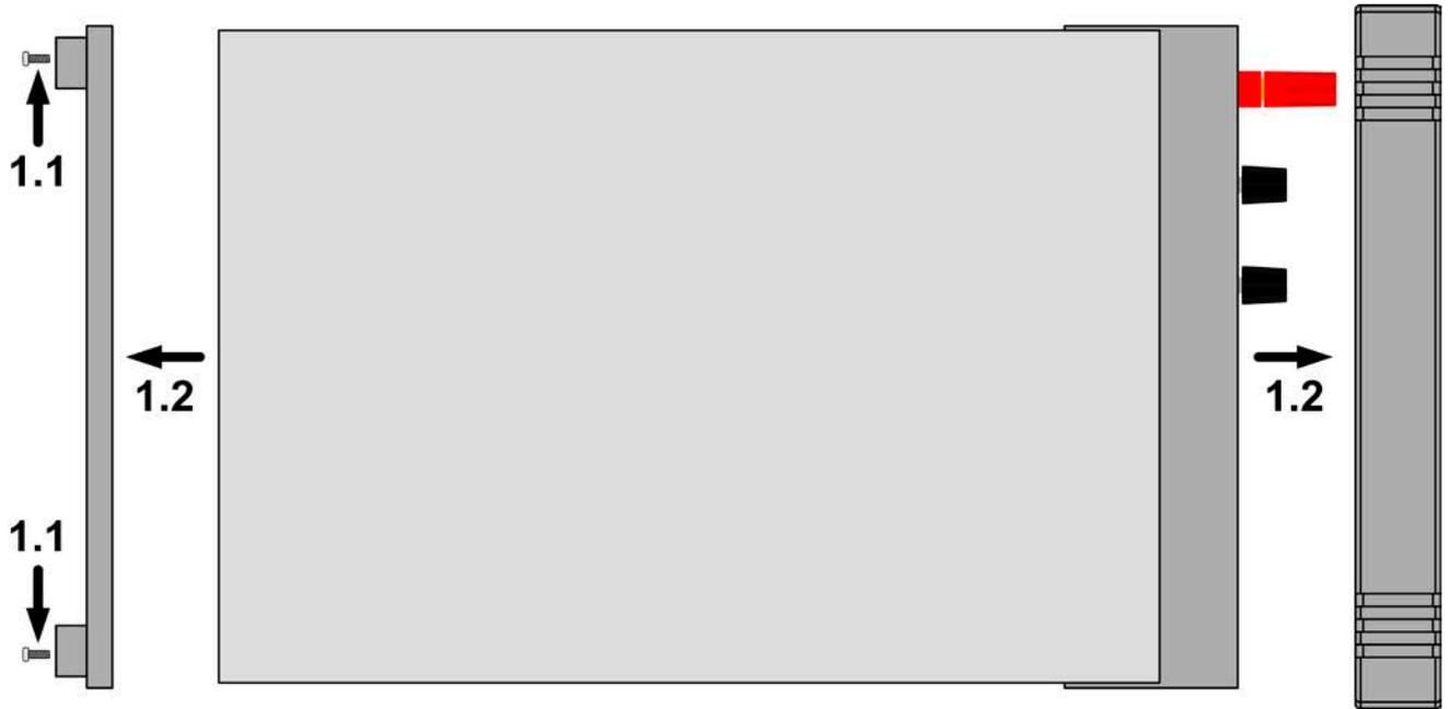
Рисунок 8 - Демонтаж передней и задней рамы
