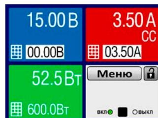
3. После успешного выбора желаемое значение можно установить внутри определённых лимитов. Выбирается цифра нажатием ручки, курсор сдвигается влево (выбранная цифра будет подчеркнута):
