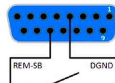
При удалённом управлении, пин REM-SB может быть использован для включения и выключения входа DC. Это также возможно без удалённого управления.
