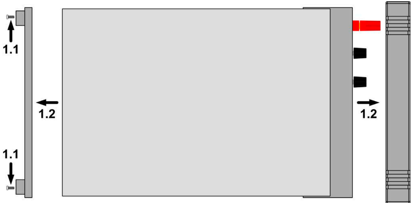
Рисунок 7 - Демонтаж передней и задней рамы
