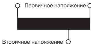
Таким образом, вместо трансформатора на номинальную мощность 1000 ВА можно применить трансформатор на мощность 425 ВА.
