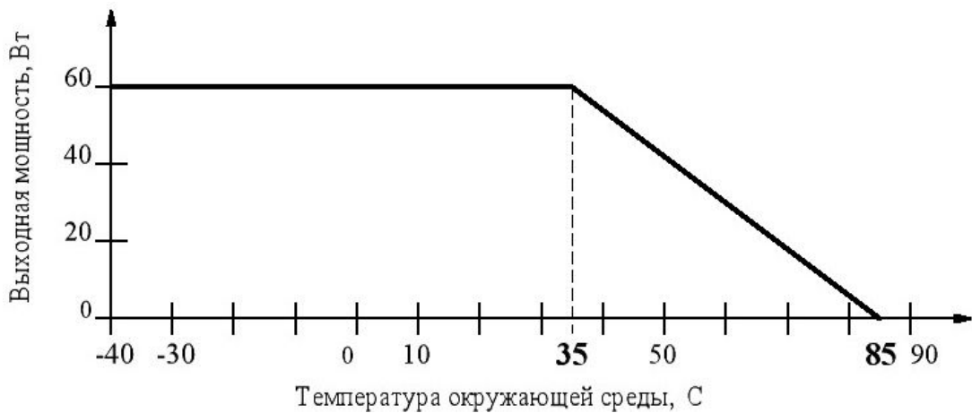
Рисунок Е.2 – Зависимость выходной мощности от температуры окружающей среды в условиях естественной конвекции (для К.П.Д. = 85 %)
