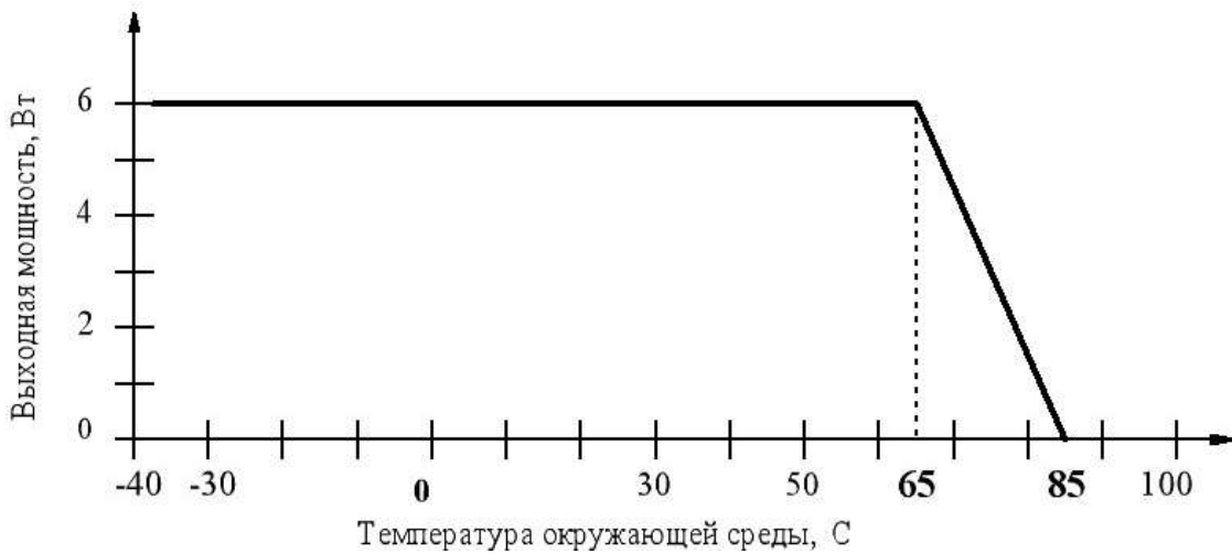
Рисунок Е.2 – Зависимость выходной мощности от температуры окружающей среды в условиях естественной конвекции (для К.П.Д. = 80 %)
