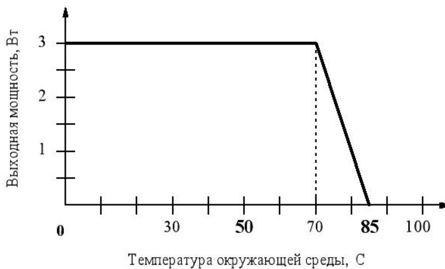
Рисунок Е.2 – Зависимость выходной мощности от температуры окружающей среды в условиях естественной конвекции (для К.П.Д. = 80 %)
