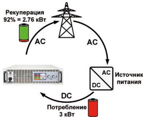
При операциях, данных нагрузок с реверсией энергии, для генерации электроэнергии для электроэнергетических компаний, возможно потребуется установить модуль контроля (AIU, ENS), в соответствии с положениями поставщика электроэнергии.
