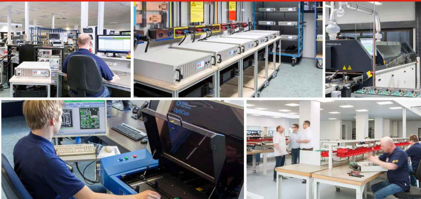
Все данные тестов и калибровки записываются и их можно восстановить. Следуя конечному контролю, все устройство подвергаются термоиспытанию под максимальной нагрузкой. Это выполняется при окружающей температуре 40°C с использованием электронной нагрузки с рекуперацией энергии. Таким образом, потребляемая энергия не преобразуется в тепло, а возвращается во внутреннюю электросеть.
