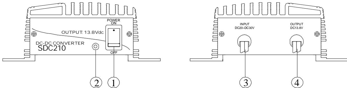
1. **POWER SWITCH:** Switch ON/OFF the unit.
